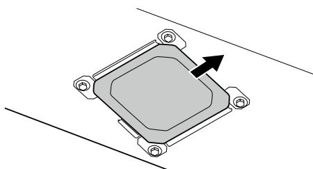
Retire los filtros del ventilador de extracción viejos.
