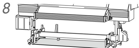
Durch Ausbreiten nicht benötigter Medien oder Tücher können Sie verhindern, dass der Boden mit Tinte verschmiert wird, die aus den alten Absauggebläsefiltern tropft.
