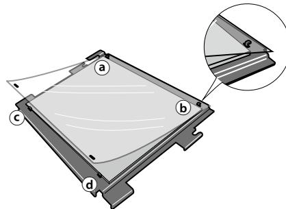
Attachez deux orifices de la feuille de support aux emplacements de fixation (a) et (b) de la monture de feuille de nettoyage. Étendez bien la feuille et attachez les deux orifices restants aux emplacements de fixation (c) et (d).
