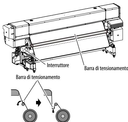
Regolare la lunghezza della barra di tensionamento e decidere se collegare una flangia o meno, a seconda del tipo e della larghezza del supporto.
