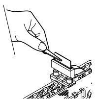
**4** Pellizque la goma de la nueva escobilla de limpieza con las pinzas, insértela recta hacia abajo y enganche el saliente de plástico en el orificio practicado en la goma.
