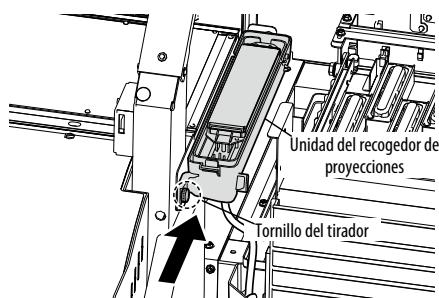
Instale la nueva unidad del recogedor de proyecciones con el tornillo del tirador.
