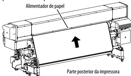
Se for difícil inserir a extremidade da mídia no alimentador de papel devido a enrolamento da mídia, coloque uma folha lisa e insira a extremidade da mídia sob a folha vazia conforme mostrado na figura abaixo.
