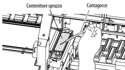
Inumidire il contenitore dello spruzzo con il liquido di assorbimento spruzzi utilizzando un contagocce.
