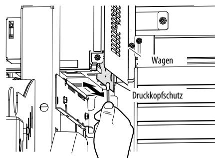
Reinigen Sie den Druckkopfschutz auf der rechten und linken Seite des Wagens mit einem Reinigungsstäbchen oder einem weichen Tuch.
