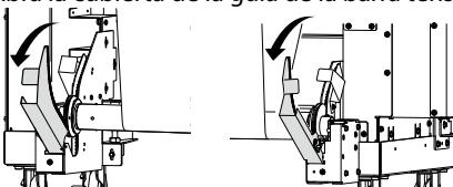
**3** Coloque la barra tensora en el gancho de la barra tensora.
