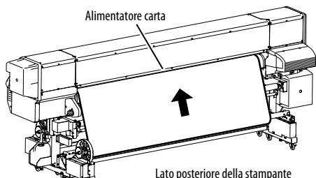
Se l'ondulazione dell'estremità del supporto rende difficile l'inserimento nell'alimentatore, frapporre un foglio tra il supporto da sotto il foglio come mostrato in figura di seguito.
