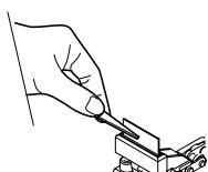
**4** Utilizando as pinças, agarre a nova palheta de limpeza pela borracha e insira-a na vertical, engatando o orifício existente na borracha na projecção de plástico.
