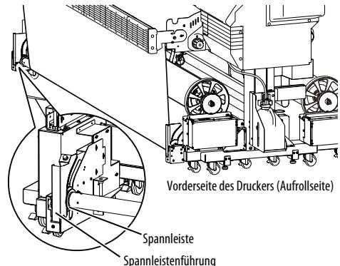
**11** Öffnen Sie die Abdeckung der Spannleistenführung.
