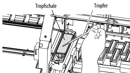
Befeuchten Sie das Tropfschale mithilfe eines Tropfers mit Tropfschalen-Absorberflüssigkeit.
