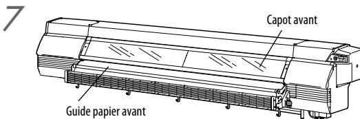
Si l'imprimante est salie par de la poussière ou de la poussière de papier, retirez-la à l'aide d'un aspirateur. Si les impuretés sont nombreuses, retirez-les avec un chiffon doux humidifié avec un détergent neutre.
