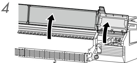
Abra la cubierta delantera y, a continuación, la cubierta de la unidad de tapado.
