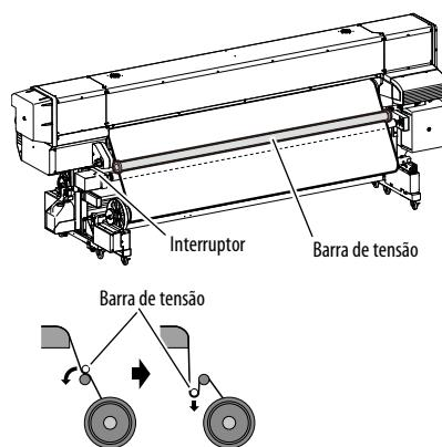
Ajuste o comprimento da barra de tensão e determine se necessita de instalar um friso ou não, consoante o tipo e a largura do papel.
