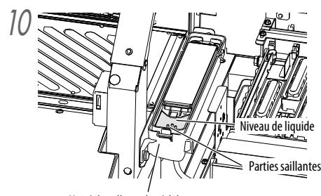
Versez le liquide du réceptacle dans le boîtier réceptacle jusqu'à ce que le niveau de liquide soit aussi haut que les parties saillantes d'indication.
