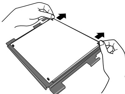
Éliminez tous les froissements de la feuille de nettoyage de tête en tirant légèrement sur les deux côtés du bord supérieur de la feuille dans le sens des flèches. Ceci sert à empêcher que la feuille ne se soulève près des emplacements de fixation du bord inférieur.
