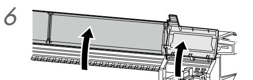
Öffnen Sie die vordere Abdeckung und öffnen Sie dann die Deckplatte.
