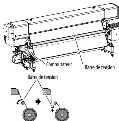
Ajustez la longueur de la barre de tension et décidez de fixer ou non une collerette, selon le type et la largeur du support.
