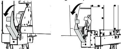
3 Hängen Sie die Spannleiste in den Spannleistenhaken ein.
