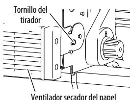
**10** Tire hacia usted del ventilador secador del papel y gírelo 90 grados hacia arriba.
