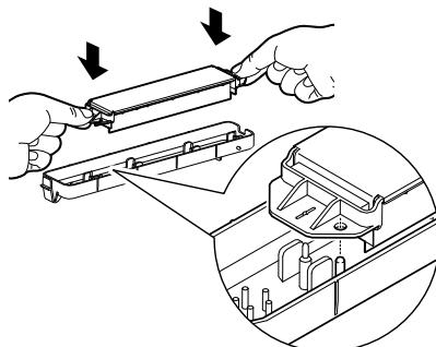
Posizionare il foro di posizionamento del nuovo contenitore dello spruzzo sulla sporgenza e fissarlo orizzontalmente con una lieve pressione.
