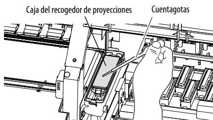
Humedezca la caja del recogedor de proyecciones con el líquido absorbente del recogedor de proyecciones utilizando un cuentagotas.
