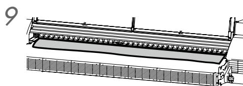
Durch Ausbreiten nicht benötigter Medien oder Tücher auf der Platte können Sie verhindern, dass der Drucker mit Staub verschmiert wird, der sich an den Abluftgebläsefiltern ansammelt.
