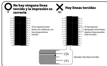
Chequee que no faltan líneas o hay líneas torcidas. Si faltan líneas o hay líneas torcidas en la impresión de inyectores, realice una limpieza normal.
