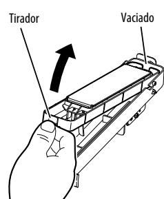
Presione el tirador junto a la caja que contiene el líquido absorbente del recogedor de proyecciones para abrir la tapa, levante la parte delantera de la caja del líquido absorbente del recogedor de proyecciones para vaciar el líquido en la parte trasera.
