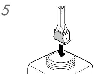
Imbibez la tige de nettoyage avec le liquide de nettoyage des protections.
