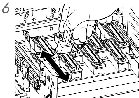
**6** Limpe a superfície de topo da cápsula fazendo deslizar o rolo de limpeza.
