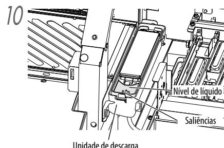
Derrame o líquido absorvente de descarga dentro da caixa de descarga até que o nível do líquido fique tão elevado quanto as saliências de indicação.
