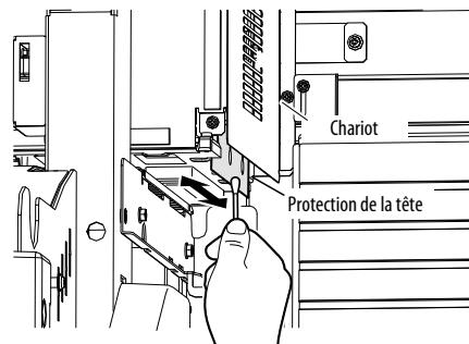
Nettoyez la protection de la tête des côtés droit et gauche du chariot à l'aide d'un coton de nettoyage ou d'un chiffon doux.
