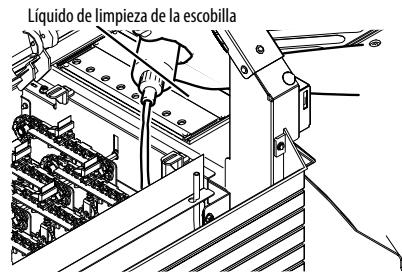
Cuando el nivel del líquido de limpieza esté por debajo del borde superior de la marca "**X**", rellene el líquido de limpieza de la escobilla.
