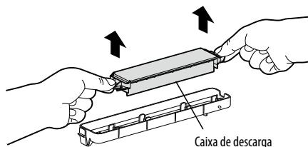
Segure os suportes de encaixe em ambos os lados da caixa de descarga. Em seguida, retire a caixa de descarga levantando-o.
