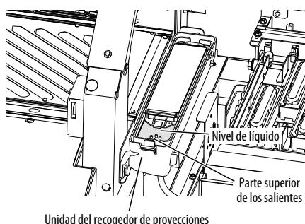
Compruebe que la superficie superior del líquido absorbente del recogedor está a la misma altura que la parte superior de los salientes.
