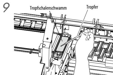
Befeuchten Sie den Tropfschalenschwamm mithilfe eines Tropfers mit Tropfschalen-Absorberflüssigkeit.
