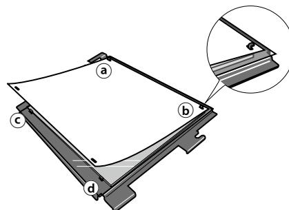
Coloque la hoja de limpieza del cabezal sobre la hoja de apoyo. Enganche dos agujeros a las posiciones para accesorios (a) y (b) y, a continuación, los otros dos agujeros a las posiciones para accesorios (c) y (d).
