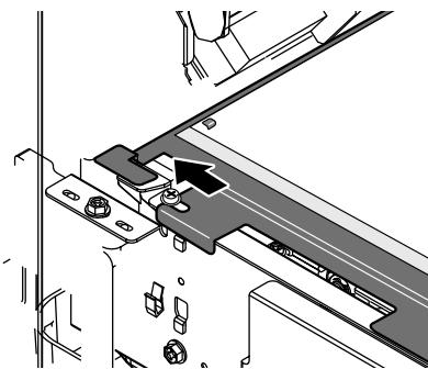
Installez la pièce de nettoyage par feuille préparée à l'avance sur l'unité d'essuyage.
