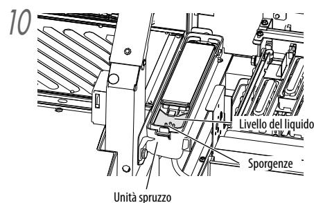
Versare il liquido di assorbimento spruzzi nel contenitore dello spruzzo finché il livello di liquido non raggiunge le sporgenze dell'indicazione.
