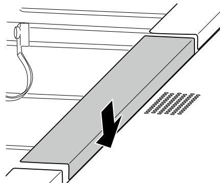
Retire los filtros del ventilador de succión viejos del sistema de enganche y sujeción.
