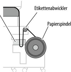
Lockern Sie das Medium auf eine Ebene, die unter dem Schlupsensor auf der Abrollseite liegt.
