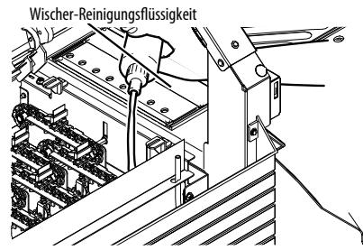
Sollte der Reinigungsflüssigkeitsstand niedriger als die obere Kante der "X"-Markierung sein, füllen Sie Wischer-Reinigungsflüssigkeit nach.
