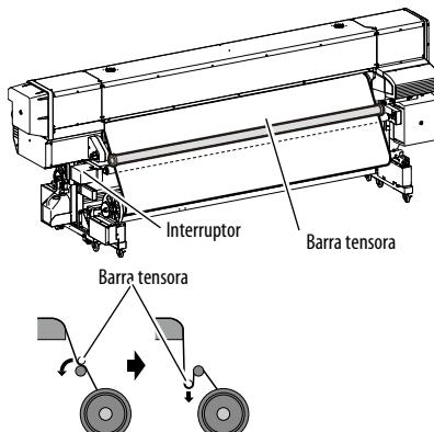
Ajuste la longitud de la barra tensora y decida si acoplar o no una base, dependiendo del tipo y de la anchura del papel.
