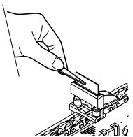
**4** Saisissez le caoutchouc du nouvel essuie-glace avec les pinces et insérez-le tout droit, puis installez-le en fixant l'orifice du caoutchouc à la projection en plastique.
