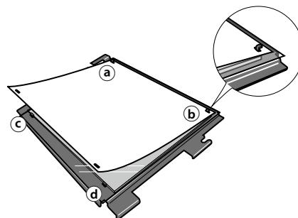
Coloque a folha de limpeza de cabeçote sobre a folha de suporte. Enganche em dois furos nos locais de prender (a) e (b) e os dois outros furos nos locais de prender (c) e (d).
