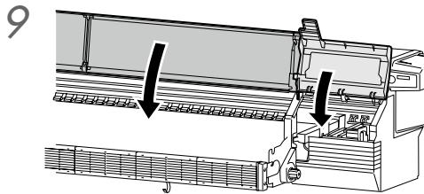
Cierre la cubierta de la unidad de tapado y la cubierta delantera.
