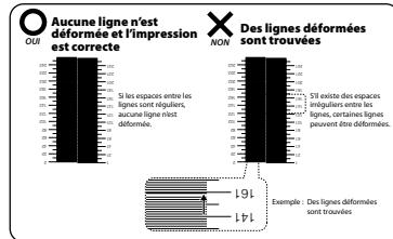
Vérifiez qu'aucune ligne ne manque ou n'est déformée. Si vous remarquez des lignes manquantes ou déformées sur la page de test, effectuez un nettoyage normal. Si les lignes manquantes ou déformées persistent après plusieurs nettoyages normaux, réglez **[PLAN BUSE]** avec la procédure ci-dessous.
