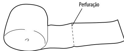
A partir de um rolo de filtro novo, arranque a quantidade necessária ao longo da perfuração para a substituição.
