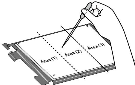
Aplique 4 cc de líquido de limpieza de la escobilla a la superficie de la hoja de limpieza del cabezal mediante un cuentagotas. Aplique 1 cc cuatro veces de la siguiente forma.
