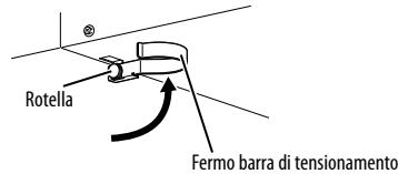
**13** Posizionare un carrello sotto il supporto e sollevare il supporto per rimuoverlo.
