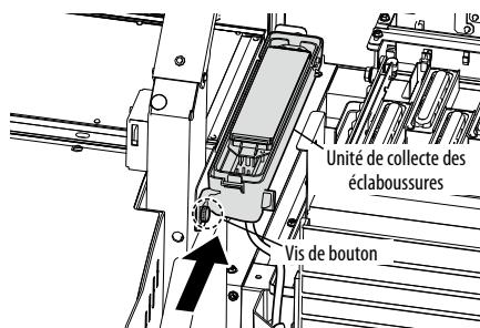
Installez la nouvelle unité de collecte des éclaboussures avec la vis de bouton.
