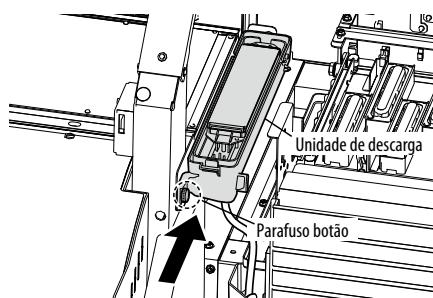
Instale a nova unidade de descarga com o parafuso.
