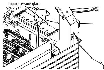
Lorsque le niveau de liquide essuie-glace est inférieur au bord supérieur de la marque « **X** », faites l'appoint de liquide essuie-glace.
