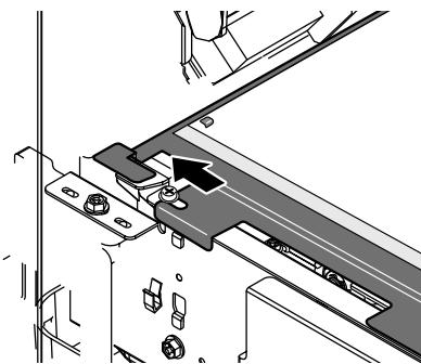
Montieren Sie das zuvor vorbereiteten Putzblattteil an der Abstreifeinheit.
