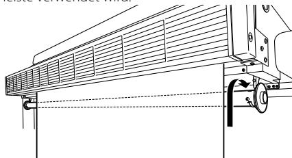
4 Öffnen Sie die Vorderabdeckung, und schneiden Sie das Medium ab.
