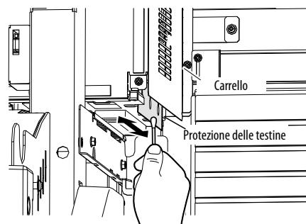
Pulire la protezione delle testine sui lati destro e sinistro del carrello utilizzando un tampone di pulizia o un panno morbido.
