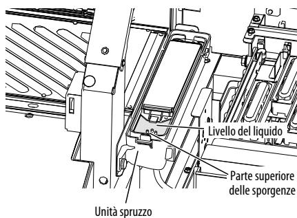
Controllare che la superficie superiore del liquido di assorbimento spruzzi raggiunga la parte superiore delle sporgenze.
