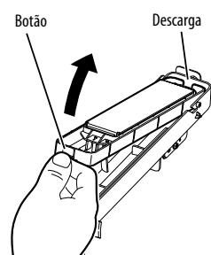
Pressione o botão no lado mais próximo do compartimento que contém o líquido absorvedor de descarga para abrir a tampa, levante a parte da frente do compartimento do líquido absorvedor de descarga para descarregar o líquido absorvedor de descarga à parte traseira.
