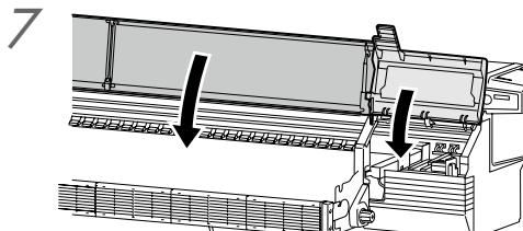
Schließen Sie die Deckplatte und die vordere Abdeckung.
