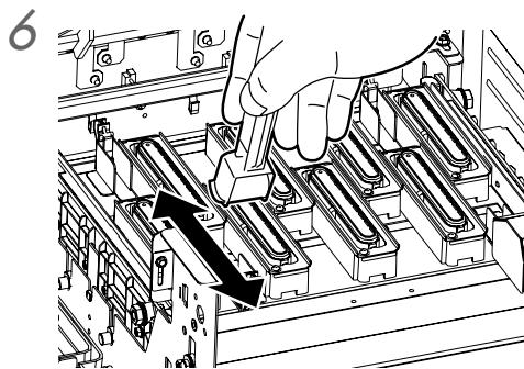
**Nettoyez la surface supérieure de la protection en faisant rouler le rouleau de nettoyage.**
