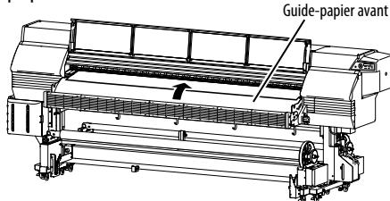
Rechargez le support tout en appuyant sans forcer sur le centre du support du côté sortie.
