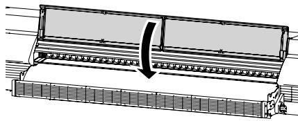
Rimuovere il supporto o il panno installato al passaggio 3 e chiudere il coperchio anteriore.
