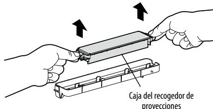
Sujete la caja del recogedor de proyecciones por las pestañas de ambos extremos.
