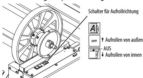
**9** Schieben Sie das Medium mit dem Menü SEITENVORSCH auf dem Bedienfeld vor, so dass es einmal um die Papierröhre gewickelt wird. Setzen Sie den Schalter für die Aufrollrichtung auf AUS.
