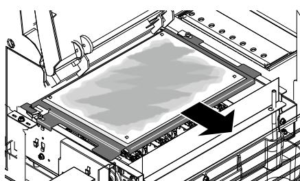
Extraiga la pieza para la limpieza por hojas situada en la parte superior de la unidad de limpieza y, a continuación, cierre las cubiertas.
