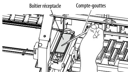
Humidifiez le boîtier réceptacle avec le liquide du réceptacle à l'aide d'un compte-gouttes.
