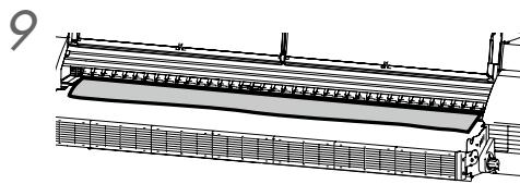
Installez un support inutilisable ou du tissu sur le plateau afin d'éviter de tacher l'imprimante avec la poussière accumulée sur les filtres de ventilateur d'échappement.
