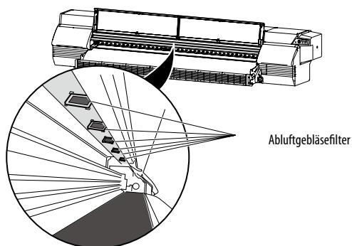
Wenn Sie die Abluftgebläsefilter über das Menü des Bedienfelds ersetzen, beginnen Sie den Vorgang bei Schritt 1. Wenn Sie das Ersetzen während der Ausführung von [#ANFANGSWARTUNG] durchführen, beginnen Sie den Vorgang bei Schritt 6. Sie werden während der Anleitung zur Anfangswartung aufgefordert, die Abluftgebläsefilter nach einem Monat oder 0,8 km Drucklänge zu ersetzen.
