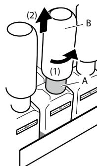
Gire lentamente la parte B en la dirección de las agujas del reloj mientras sujetas la parte A con la mano para evitar que esta gire.
