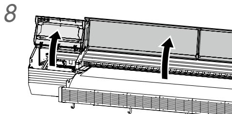
Abra la cubierta delantera y, a continuación, la cubierta de limpieza.
