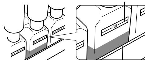
Bordo del contenitore del sistema di inchiostro ad alta capacità
