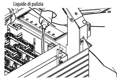
Quando il livello del liquido di pulizia è inferiore al bordo superiore del simbolo "**X**", rabboccare il liquido di pulizia.
