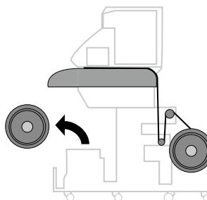
Wenn sich das Medium in der Aufwickelpulen-Einheit befindet, entfernen Sie es.
