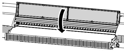
Entfernen Sie das Medium oder Tuch, das Sie in Schritt 3 verlegt haben, und schließen Sie die vordere Abdeckung.
