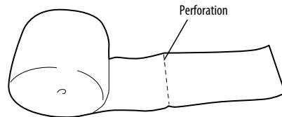
Reißen Sie von einer neuen Filterrolle entlang der Perforation die für den Austausch benötigte Menge ab.
