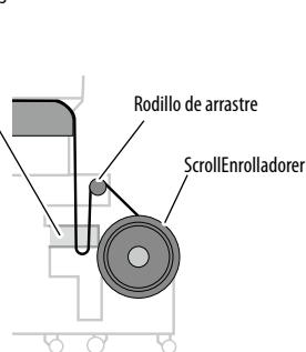
Afloje hasta alcanzar un nivel por debajo del sensor de holgura del lado de suministro.
