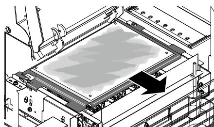
Remova a peça para limpeza com folha no topo da unidade de limpeza e depois feche as tampas.
