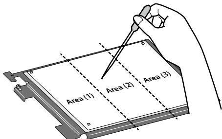
Applicare 4 cc di liquido di pulizia sulla superficie del foglio di pulizia delle testine utilizzando un contagocce.
