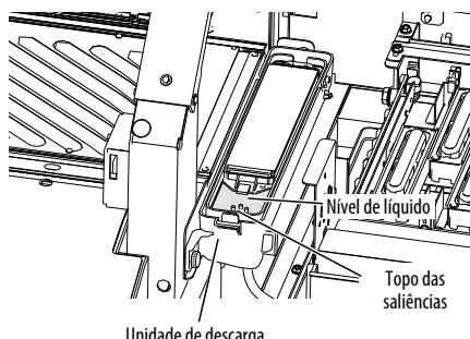
Confirme que a superfície superior do líquido absorvedor de descarga está tão elevada como a parte superior das saliências.
