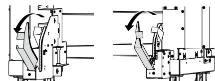
**12** Setzen Sie die Spannleiste unten in die Führung ein.
