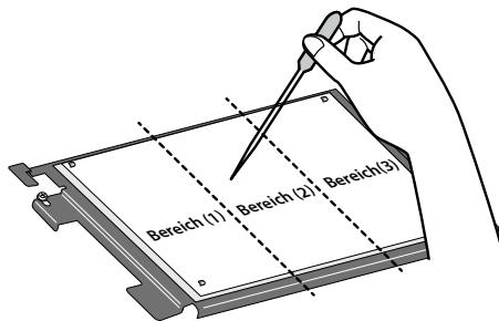
Tragen Sie mit einem Tropfer 4 ccm Wischer-Reinigungsflüssigkeit auf die Oberfläche des Druckkopfputzblattes auf. Tragen Sie viermal 1 ccm folgendermaßen auf.
