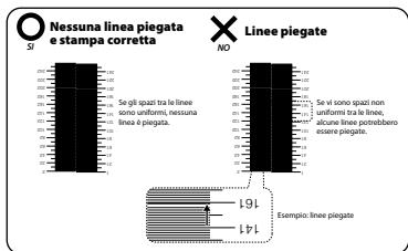
Controllare che non vi siano linee mancanti o piegate. Se nella stampa ugelli si rilevano linee mancanti o piegate, effettuare la pulizia normale.
