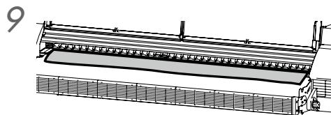
Installando un supporto non necessario o un panno sulla piastra, evitare che la stampante si macchi con la polvere accumulatisi sui filtri della ventola di scarico.
