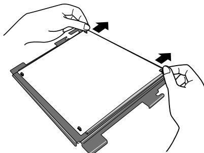
Remova todos os vincos na folha de limpeza de cabeçote, puxando levemente ambos os lados do canto superior da folha na direção das setas. Isto impedirá que a folha levante perto dos locais de prender no canto inferior.
