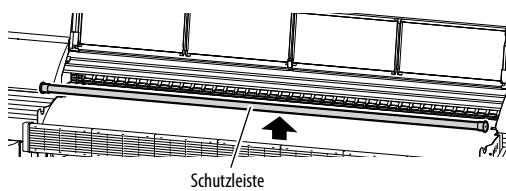
9 Lösen Sie die Knopfschrauben rechts und links neben dem beweglichen Medientrockner.
