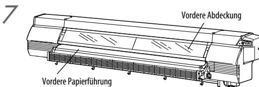
Falls der Drucker mit Staub und Papierstaub verschmutzt ist, entfernen Sie den Staub mit einem Staubsauger. Wenn die Verschmutzung sehr stark ist, wischen Sie sie mit einem weichen Tuch und einem neutralen Reinigungsmittel ab.
