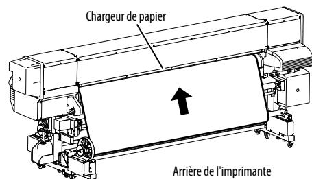
Si vous avez des difficultés à insérer l'extrémité du support dans le chargeur de papier en raison d'un gondollement du support, placez une feuille intercalaire et insérez l'extrémité du support sous la feuille intercalaire comme illustré ci-dessous.
