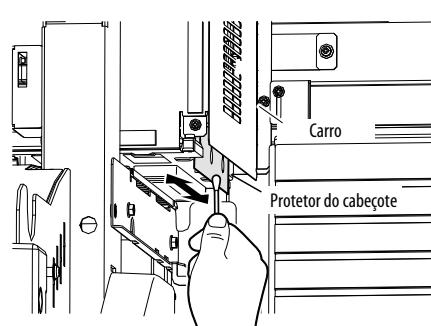
Limpe o protetor do cabeçote nos lados direito e esquerdo do carro utilizando uma estopa de limpeza ou um pano macio.
