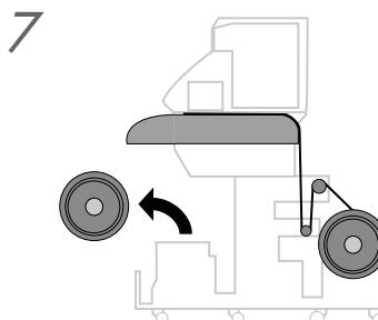
Quando il supporto è installato sull'unità bobina di avvolgimento, rimuovere il supporto.
