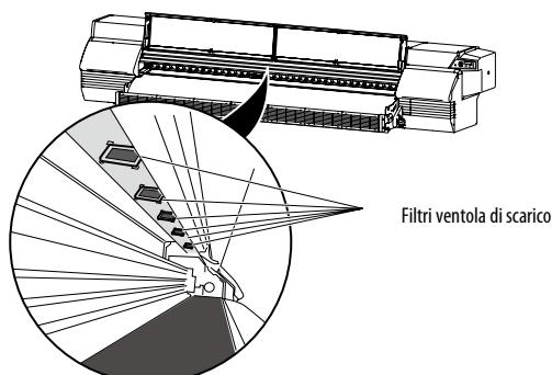
Quando si sostituiscono i filtri della ventola di scarico dal menu del pannello operatore, avviare la procedura dal passaggio 1. Quando si effettua la sostituzione durante l'esecuzione di [**#MANUTENZ INIZIALE**], avviare la procedura dal passaggio 6. Le sarà richiesto di sostituire i filtri della ventola di scarico nella guida della manutenzione iniziale dopo 1 mese o 0,8 km di lunghezza di stampa.
