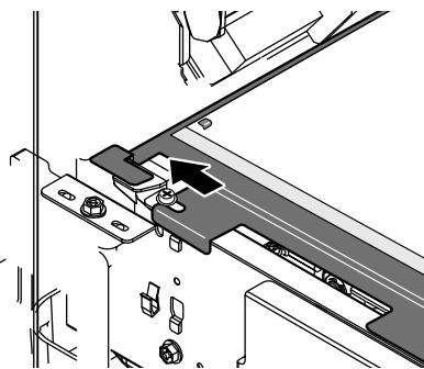
Instale a peça para limpeza com folha que você preparou antes na unidade de limpeza.
