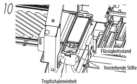
Gießen Sie die Tropfschalen-Absorberflüssigkeit in das Tropfschale, bis der Flüssigkeitsstand die Höhe der vorstehenden Markierungsstifte erreicht hat.
