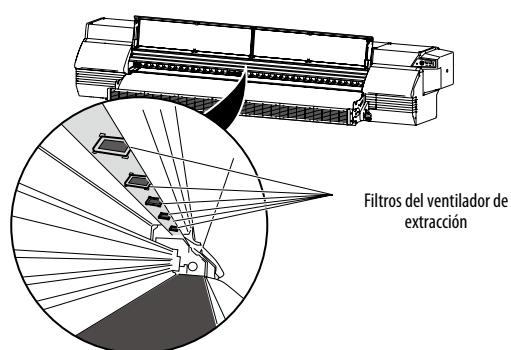
Cuando sustituya los filtros de los ventiladores de extracción desde el menú del panel de control, inicie el procedimiento desde el paso 1. Cuando sustituya los filtros de los ventiladores de extracción durante la ejecución de [**#MANTENIM. INICIAL**], inicie el procedimiento en el paso 6.
