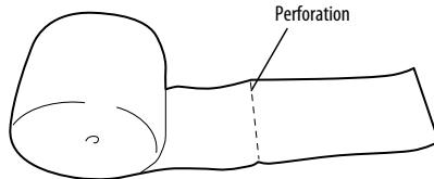
Sur un nouveau rouleau de filtre, le long de la perforation, détachez la quantité nécessaire pour le remplacement.
