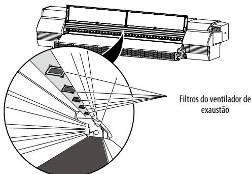
Ao substituir os filtros do ventilador de exaustão a partir do menu do painel de controlo, inicie o procedimento desde o passo 1. Ao substituir enquanto executa [**#MANUTENÇÃO INICIAL**], inicie o procedimento no passo 6.
