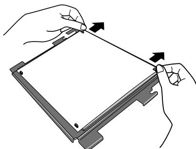
Rimuovere tutte le pieghe dal foglio di pulizia delle testine tirando delicatamente entrambi i lati del bordo superiore del foglio nella direzione delle frecce. Ciò impedirà che il foglio si sollevi vicino ai punti di attacco del bordo inferiore.
