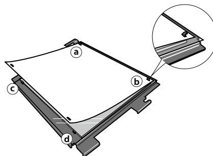
Placez la feuille de nettoyage de tête au-dessus de la feuille de support. Attachez deux orifices aux emplacements de fixation (a) et (b) puis les deux autres orifices aux emplacements de fixation (c) et (d).
