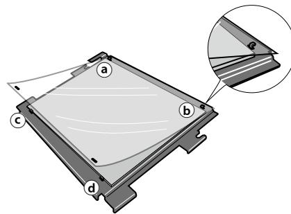
Haken Sie die beiden Löcher des Unterlageblattes in die Befestigungen (a) und (b) der Putzblatthalterung ein. Halten Sie das Blatt straff und haken Sie die beiden anderen Löcher in die Befestigungen (c) und (d) ein.
