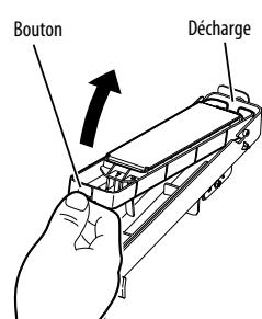
Appuyez sur le bouton près du boîtier contenant le liquide du réceptacle pour ouvrir le couvercle, soulevez l'avant du boîtier de liquide du réceptacle pour décharger le liquide à l'arrière.
