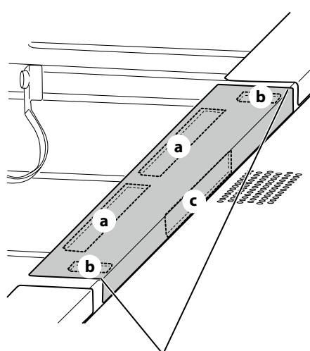
Die Längsseite des Staubfilters ist etwas länger als das Blech.
