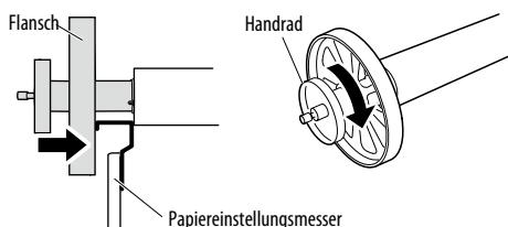
**3** Bringen Sie den Flanschabstandhalter und den Flanschverschluss so an, dass der Flanschverschluss in den Flanschabstandhalter greift.
