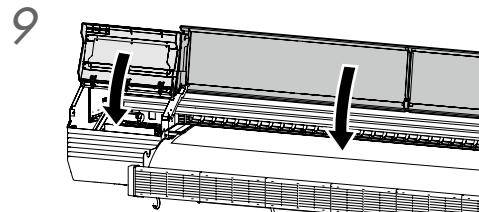
Cierre la cubierta de limpieza y, a continuación, la cubierta delantera.
