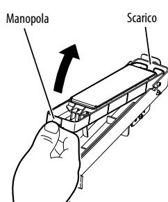
Premere la manopola sul lato in prossimità del contenitore del liquido di assorbimento spruzzi per aprire il coperchio, sollevare la parte anteriore del contenitore del liquido di assorbimento spruzzi per scaricare il liquido sulla parte posteriore.
