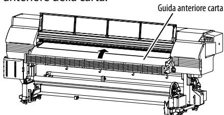
Alimentare il supporto premendo delicatamente al centro del supporto sul lato di alimentazione.
