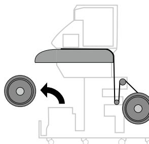
Si le support est installé sur la bobine réceptrice, retirez le support.
