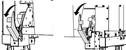
**3** Coloque a barra de tensão no respectivo grampo. Desengate a barra de tensão nos lados de recepção.
