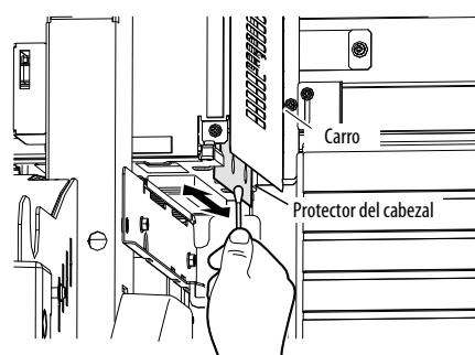
Limpie el protector del cabezal a ambos lados del carro utilizando un algodón o paño suave.
