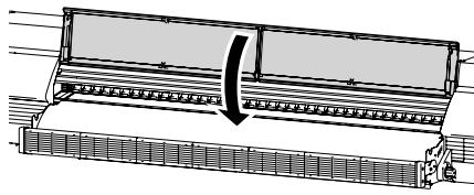
Retire los papeles o paño colocados en el paso 3 y cierre la cubierta delantera.
