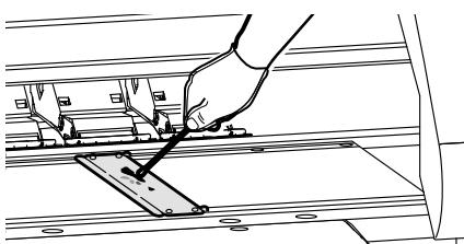
Vérifiez visuellement la présence de traces de nettoyage sur la protection des bords du support.
