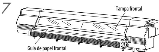
Se a impressora estiver suja com pó ou poeira do papel, remova-os usando um aspirador de pó. Se a contaminação for pesada, limpe-a com um pano macio umedecido com detergente neutro.
