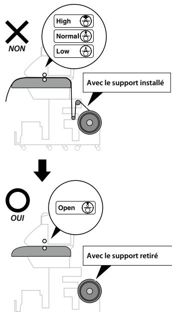
Si vous laissez le support installé dans l'imprimante pour un long moment, le support peut se froisser sur le plateau ou une trace d'attache peut être laissée sur le support. Pour maintenir le support en bon état, l'opération ci-dessous est recommandée.
