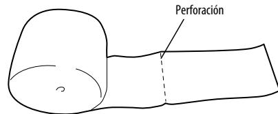
De un rollo de filtro nuevo, corte por la perforación la cantidad que necesite para la sustitución.
