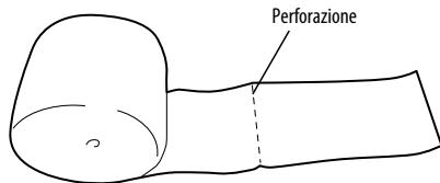
Da un nuovo rotolo filtro, strappare lungo la perforazione la quantità necessaria per la sostituzione.
