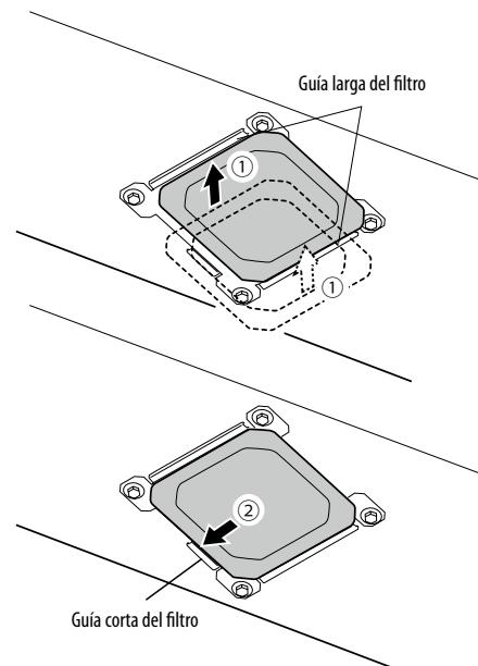
Instale los filtros del ventilador de extracción nuevos.
