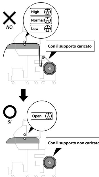
Se si mantiene a lungo il supporto caricato nella stampante, potrebbe piegarsi sulla piastra o potrebbero esservi tracce della presa sul supporto. Per tenere il supporto in buone condizioni, si consiglia l'operazione di seguito.
