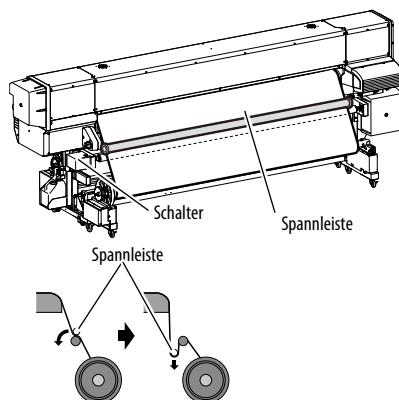
Passen Sie die Länge der Spannleiste an, und entscheiden Sie, ob ein Flansch angebracht werden muss. Dies ist abhängig von Medientyp und -breite.
