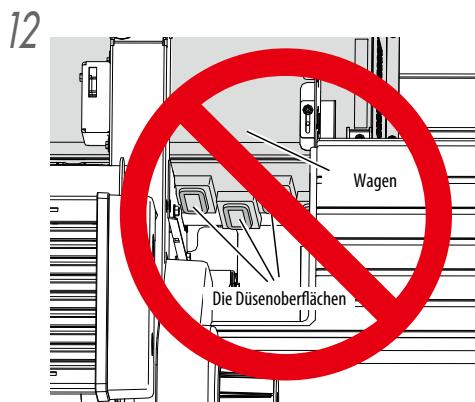
Berühren Sie bei der Reinigung nicht direkt die Düsenoberflächen.
