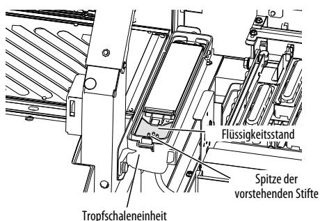
Stellen Sie sicher, dass der Flüssigkeitsstand der Tropfschalen-Absorberflüssigkeit so hoch ist wie die Spitze der vorstehenden Stifte.
