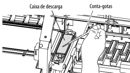
Umedeça a caixa de descarga com o líquido absorvedor de descarga usando um conta-gotas.
