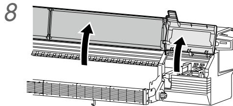
Abra la cubierta delantera y, a continuación, la cubierta de la unidad de tapado.
