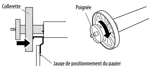
**3** Fixez la cale et la butée de la collerette en faisant en sorte que la butée de la collerette corresponde au cran de la cale.
