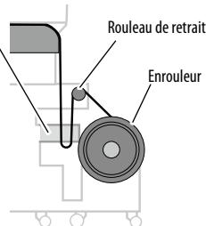
Abaissez à un niveau inférieur au capteur de desserrement côté sortie.
