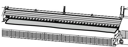
Para evitar que se extienda el polvo acumulado en los filtros del ventilador de extracción de la impresora, coloque en la platina un paño o papeles de desecho.
