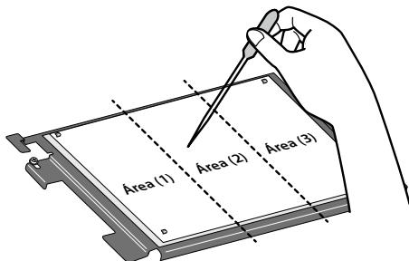
Aplique 4 cc de líquido de limpeza do limpador na superfície da folha de limpeza do cabeçote usando um conta-gotas. Aplique 1 cc quatro vezes, da seguinte maneira.
