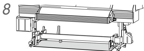
Étalez un support inutilisable ou du tissu sur le sol afin d'éviter de tacher le sol avec l'amas d'encre tombée des filtres du ventilateur aspirant.
