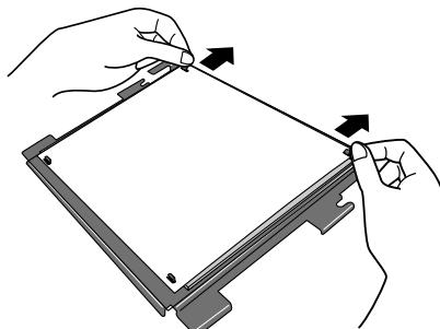
Elimine cualquier arruga de la hoja de limpieza del cabezal tirando suavemente de ambos lados del borde superior de la hoja siguiendo la dirección de las flechas. Esto evitara que la hoja se alce cerca de las posiciones para accesorios del borde inferior.
