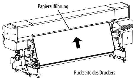
Wenn das Medienende gebogen ist und sich dadurch nur schwer in die Papierzuführung einlegen lässt, führen Sie das Medienende mithilfe eines Zwischenbaugens wie unten dargestellt ein.
