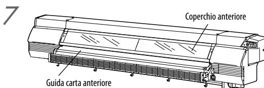
Se la stampante è macchiata di polvere e polveri di carta, rimuoverle con un aspirapolvere. In caso di eccessiva sporcizia, utilizzare un panno morbido inumidito con un detergente neutro per la pulizia.
