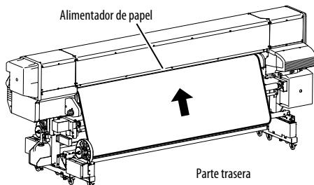
Si le resulta difícil insertar el extremo del papel en el alimentador debido a la ondulación del papel, interponga una hoja e inserte el extremo del papel debajo de la misma como se muestra en el dibujo siguiente.
