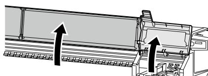
Abra la cubierta delantera y, a continuación, la cubierta de la unidad de tapado.
