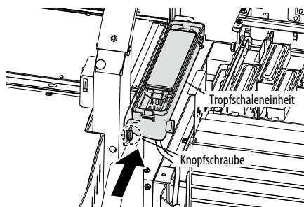
Montieren Sie mithilfe der Knopfschraube eine neue Tropfschaleneinheit.
