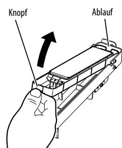
Drücken Sie den Knopf auf der Ihnen zugewandten Seite der Schale, die die Tropfschalen-Absorberflüssigkeit enthält, um den Deckel zu öffnen. Heben Sie die Vorderseite der Absorberflüssigkeitsschale an und lassen Sie die Absorberflüssigkeit auf die Rückseite ablaufen.
