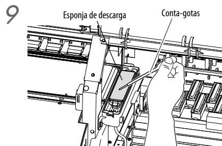
Com um conta-gotas, umedeça a esponja de descarga com o líquido absorvedor de descarga.
