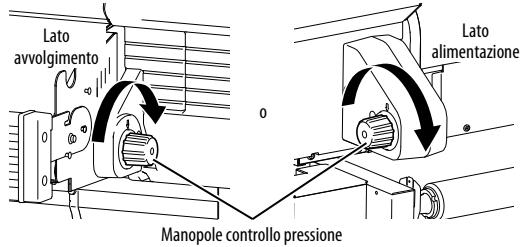
**9** Inserire l'estremità del supporto nell'alimentatore della carta distendendo manualmente il supporto per evitare la formazione di pieghe.
