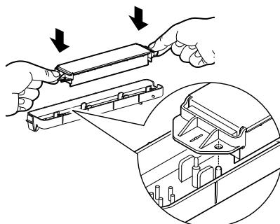
Coloque una nueva caja del recogedor de proyecciones haciendo coincidir el agujero con el saliente, y fíjela horizontalmente apretando suavemente.
