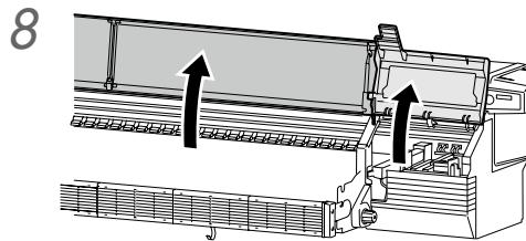
Öffnen Sie die vordere Abdeckung und öffnen Sie dann die Deckplatte.
