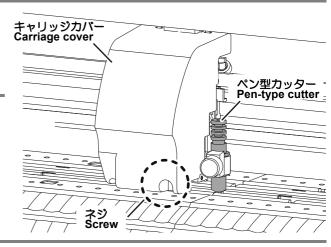
**3** ペンシャフトにカッターガードを差し込む Insert the cutter guard into the pen shaft.
