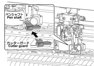
**4** カッターガードを回し、カッターガードの凸部をヨー クブラケットの凹部にはめる
