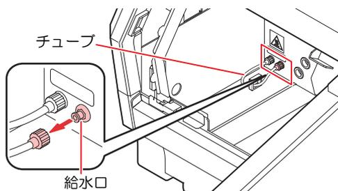
**7** 付属の容器で混合水(不凍液1、水2の割合)を作り、付属のシリンジに移す
