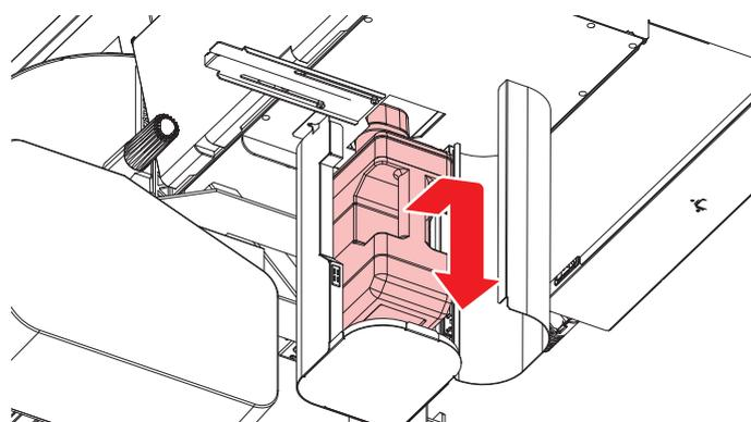
6 取り外した廃インクタンクにキャップをはめて、テープなどを使用して廃インクが漏れないように処理する。
