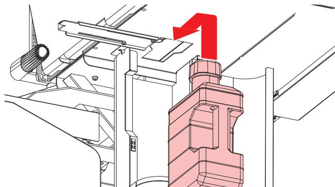
**8** ストッパーを元に戻して、廃インクタンクのカバーを閉じる。
