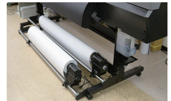
▲東京標識では「JV100-160」を少し違ったかたちで使用。工事現場サイン用のロール(幅1,000mm)とその他のロール(幅1,300mm)をデータに合わせて使い分けているのだが、通常のロールとは別に「JV100-160」の前に1本、さらに巻き取りリールにもう1本を設置、合計3本のロールをすぐに使えるようにし作業時間の短縮を図っている。(※東京標識にてオリジナルで作成)
