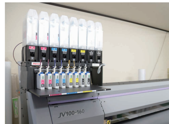
▲「JV100-160」では「AS5」インクを使用。バルクインク供給システム(2ℓ)を採用し、連日の出力業務に対応している。同機は生産重視の4色モデルのほか、8色も対応可能。
